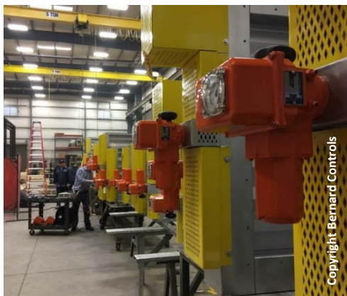
Gauche et droite : Servomoteurs quart-de-tour EZ 10 de la gamme FIRST BC
